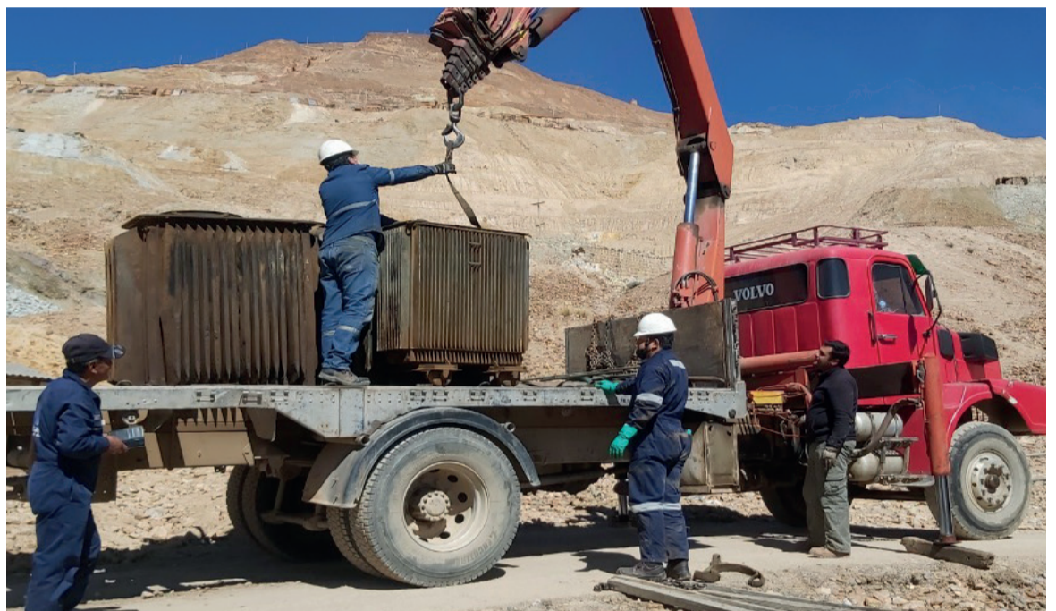
Recojo de existencias en la Empresa Minera Pailaviri de la ciudad de Potosí, de los equipos identificados cuyo contenido de Bifenilos Policlorados (PCBs) son mayores a 50 ppm.
