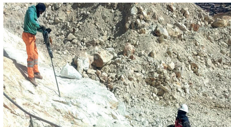
Trabajador de la unidad Productiva Caolín realizando perforación a cielo abierto
